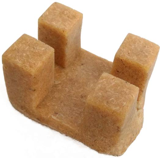
Figura 46 - Amostra do biocomposto de sisal
