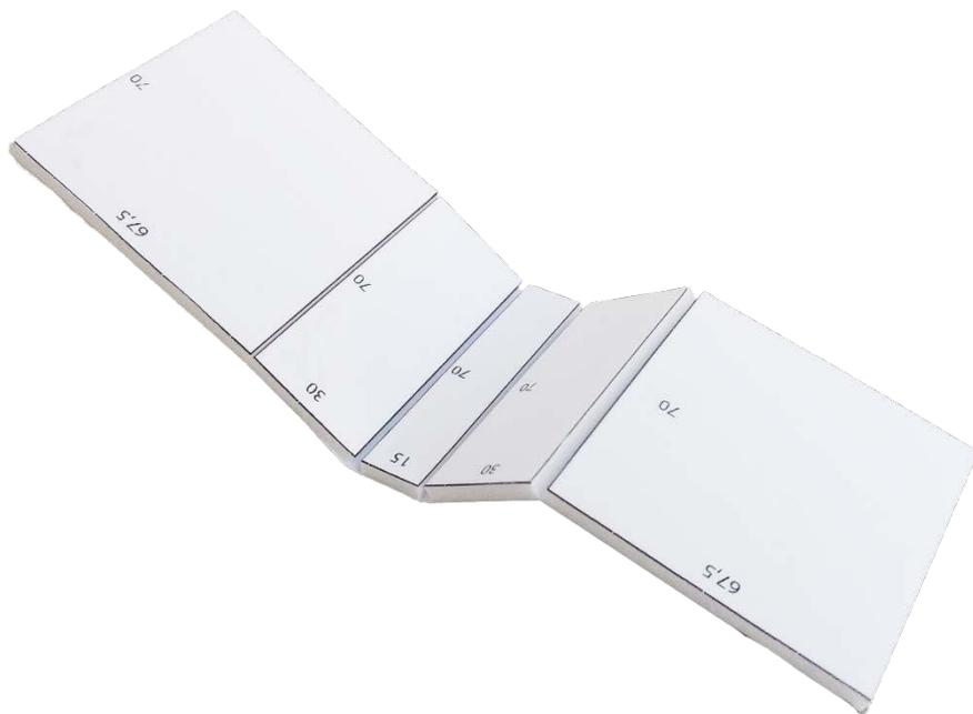
Figura 55 - Segundo modelo feito em cartão pluma. Criado exclusivamente para analisar a dimensão das partes do encosto
