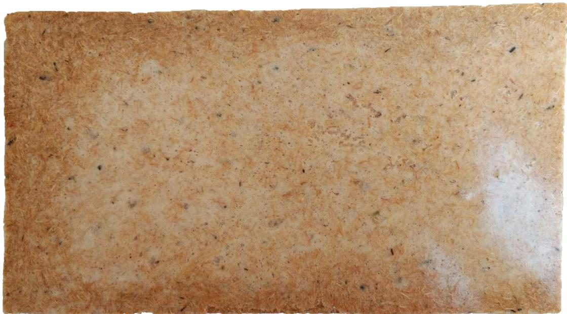
Figura 45 - Amostra do biocomposto de sisal feito com compressão
