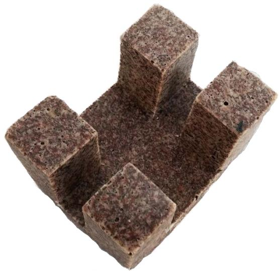
Figura 47 - Amostra do biocomposto de piaçava
