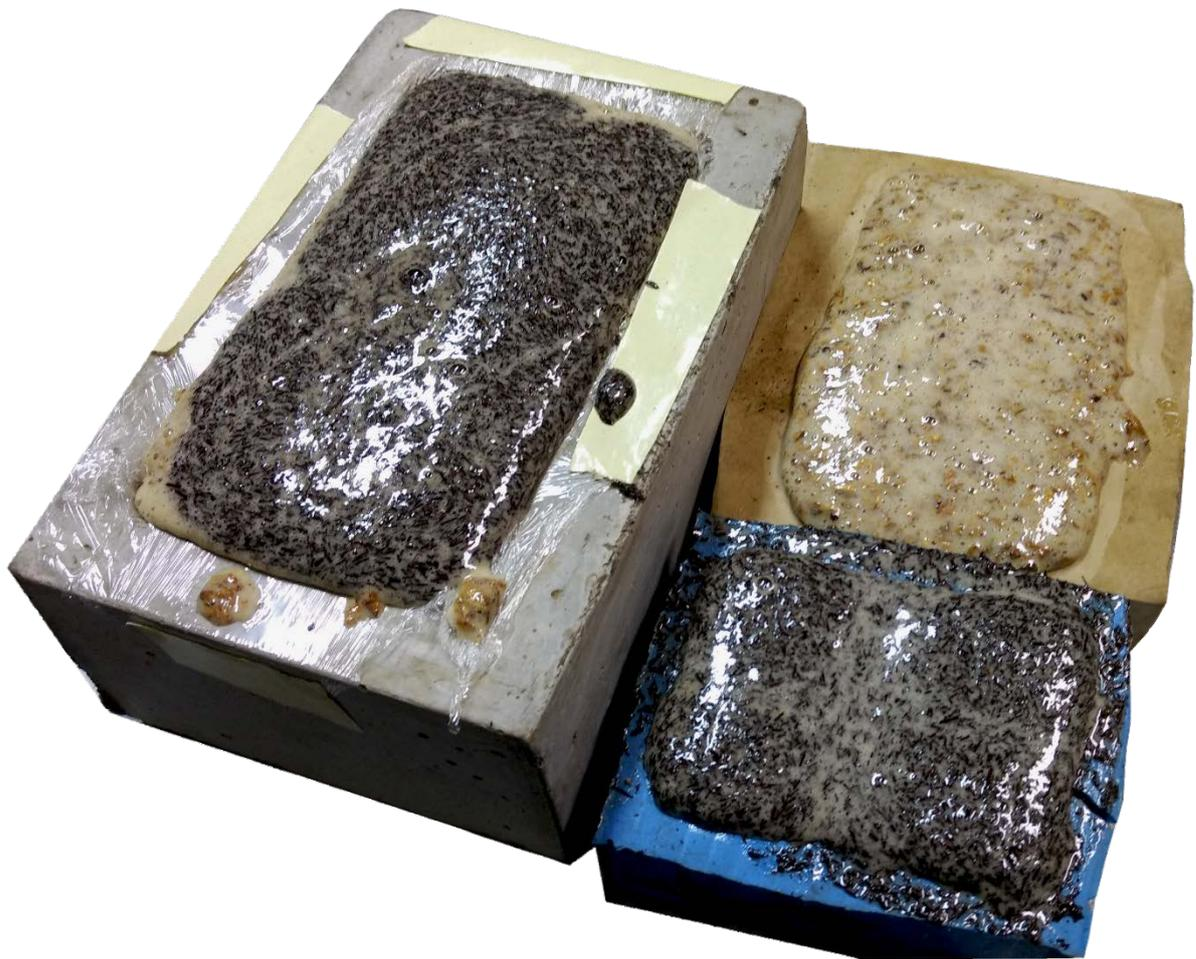
Figura 43 - Moldes de cimento e silicone com os testes do biocomposto de fibras vegetais e a Rescon 303
