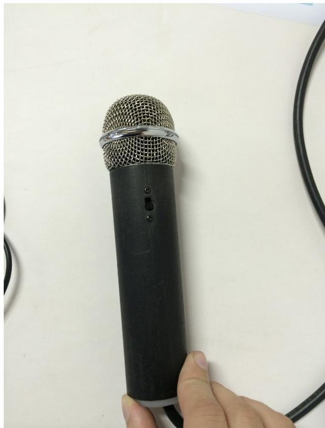
Fotos do microfone. À direita o mecanismo retirado de um microfone externo de computadores. À esquerda tudo já se encontra escondido dentro do tubo de aspirador de pó que estava na oficina.
