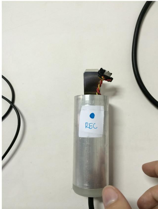
Fotos do gravador. O mecanismo eletrônico foi produzido pelo professor Reizel. Foi usado um tubo de alumínio para cobri-lo e evitar ao máximo a sensação de 'será que dá choque?'.
