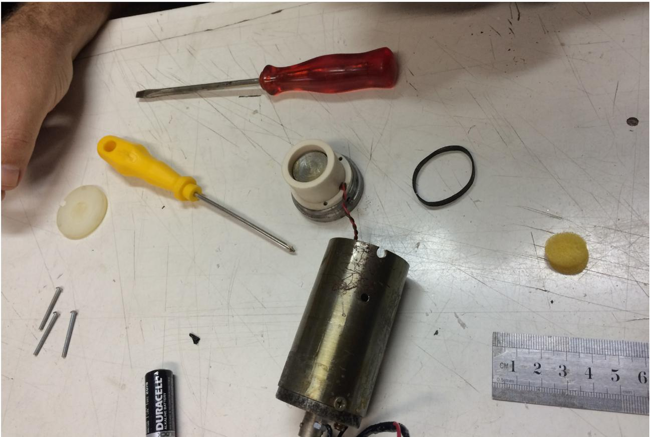
Microfone de contato aberto. Alguns testes foram feitos usando uma espuma e mola para pressionar o sensor piezo contra a base do microfone de contato para que o sinal capturado fosse o mais intenso possível.
