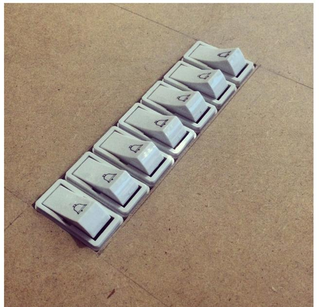
Fotos da construção da tampa com interruptores que foram fixados com cola. Os fios usados para conexão com o *Makey Makey* saíram da sucata eletrônica disponível no Motolab, da Esdi.
