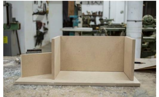
O modelo foi feito em escala 1:25 e produzido em MDF (*Medium-density fibreboard*) na própria oficina de materiais da Esdi. Desmontável, ele serviu durante todo o processo de definição do projeto expográfico para testar, de forma rápida e prática, como o conteúdo poderia se comportar na parede de apresentação da exposição e no ambiente principal dela – a primeira sala.
