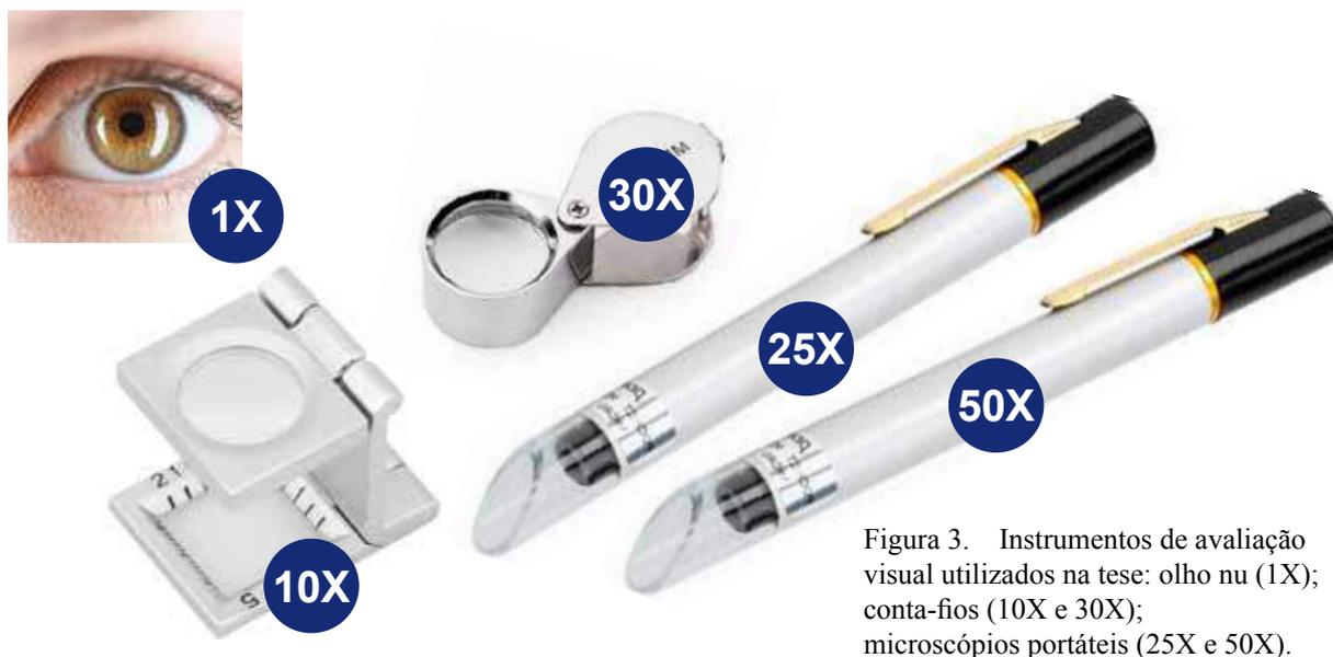
Figura 3. Instrumentos de avaliação visual utilizados na tese: olho nu (1X); conta-fios (10X e 30X); microscópios portáteis (25X e 50X).
