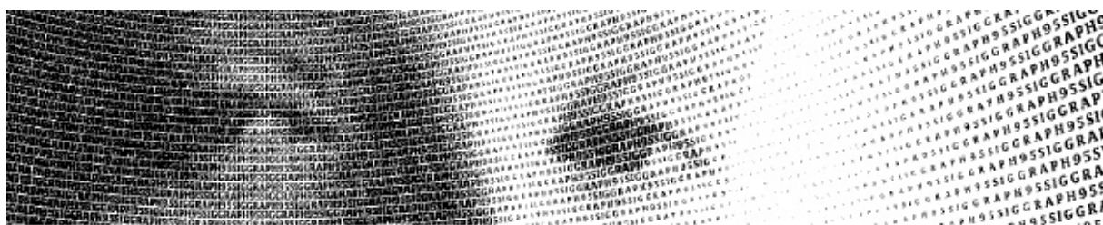
Figura 26 – Detalhe de uma imagem de tom contínuo reproduzida com retícula não convencional (letras de tamanho e espessura variáveis).
