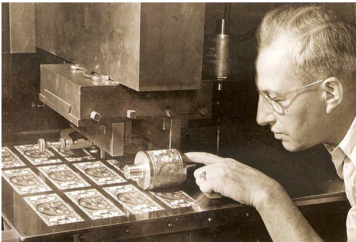
Figura 21 – Demonstração do processo de preparação de chapa impressora por siderografia.
