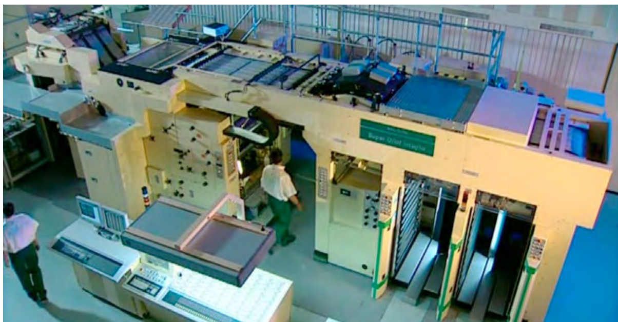
Figura 13 – Máquina para impressão calcográfica Super Orlof Intaglio.
