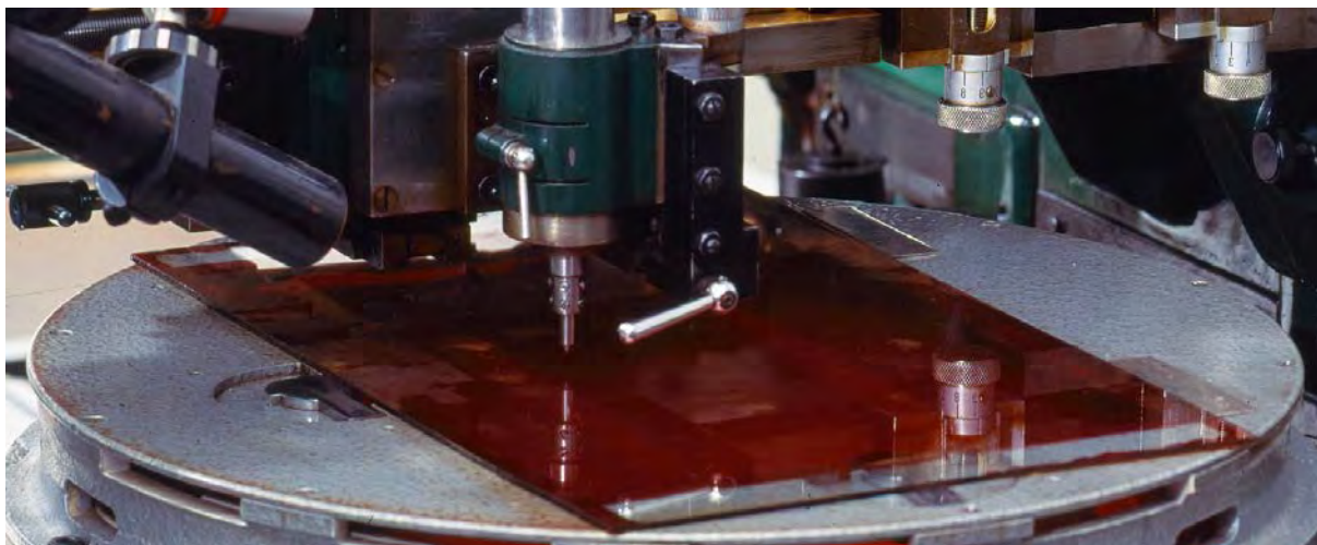
Figura 24 – Detalhe da Figura 23 mostrando a ferramenta de gravação e a placa de vidro encoberta de verniz vermelho, posicionada na mesa de gravação.
