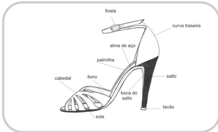
Figura 13 - As partes constitutivas do calçado feminino – modelo sandália de salto alto. Fonte: elaborado pela autora.
