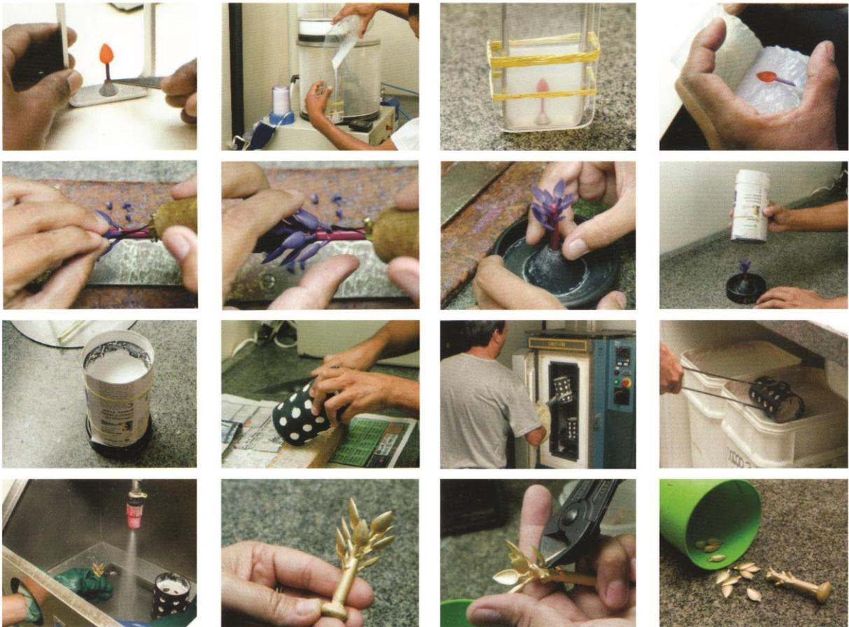
Legenda: Fotos do processo de fundição por cera perdida, começando pela confecção de molde silicone a partir de resina, seguida pela confecção da árvore de cera, depois a confecção do revestimento de gesso, deceração e fundição em forno próprio, resultando na peça em ouro.
