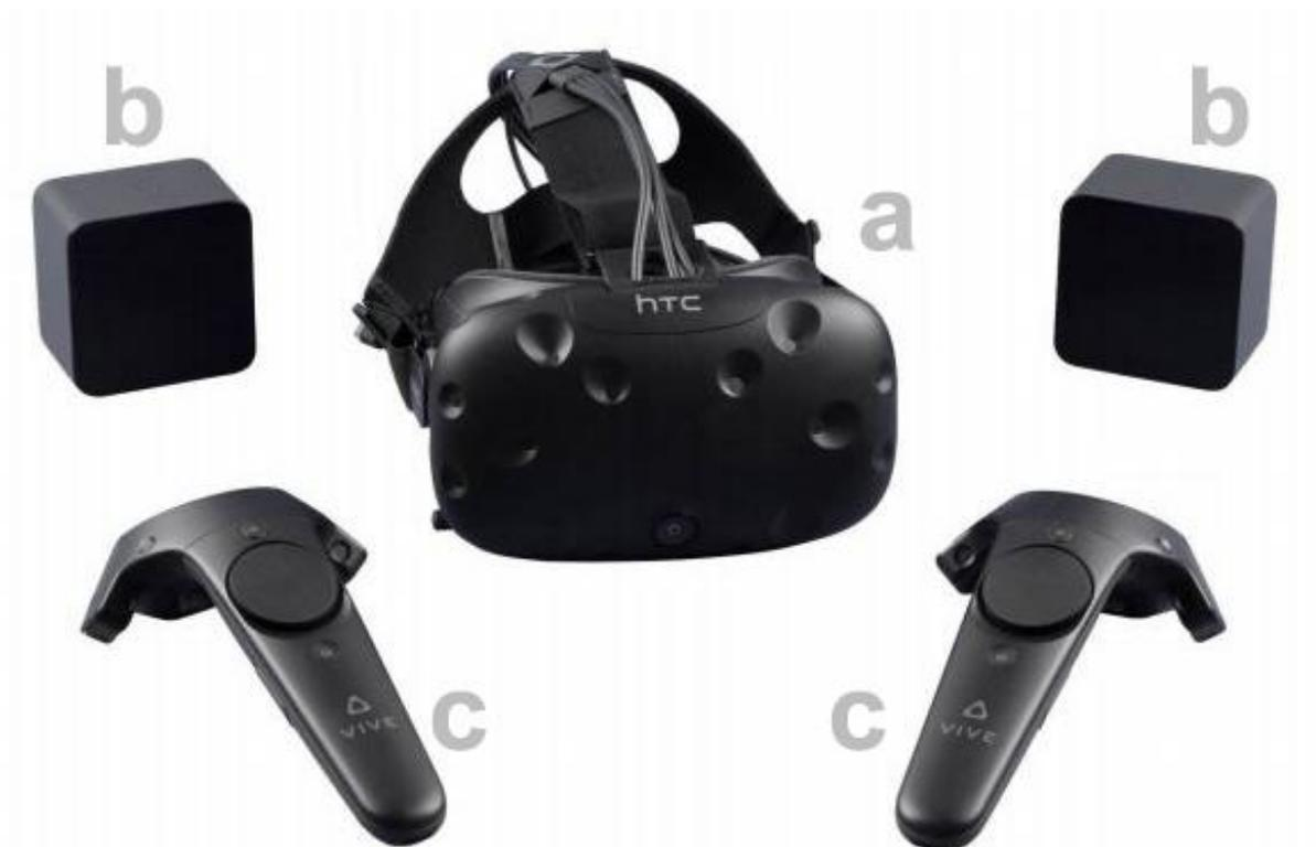
Figura 6. Composição do conjunto HTC Vive. Fonte: electronicproducts.com (2019)
