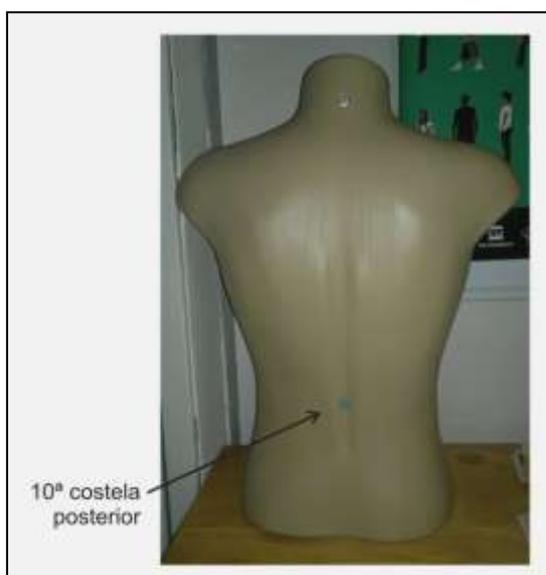
Na sessão de escaneamento do manequim no WBX, o objeto foi posicionado no centro da plataforma de escaneamento. Foi realizado um escaneamento padrão, com duração de 17 segundos. Terminado o escaneamento, o manequim foi posicionado na mesa giratória, com altura de 474 mm e a uma distância de 720 mm do *scanner* MHT. Foi realizado o escaneamento em nove etapas, rotacionando o manequim a aproximadamente 40°.
