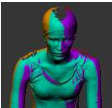
O efeito de oclusão, no qual o *laser* é impossibilitado de capturar toda a superfície gerando uma sombra (figura 51), pode ser minimizado com a aquisição de múltiplos *scans* tirados de diferentes ângulos.
