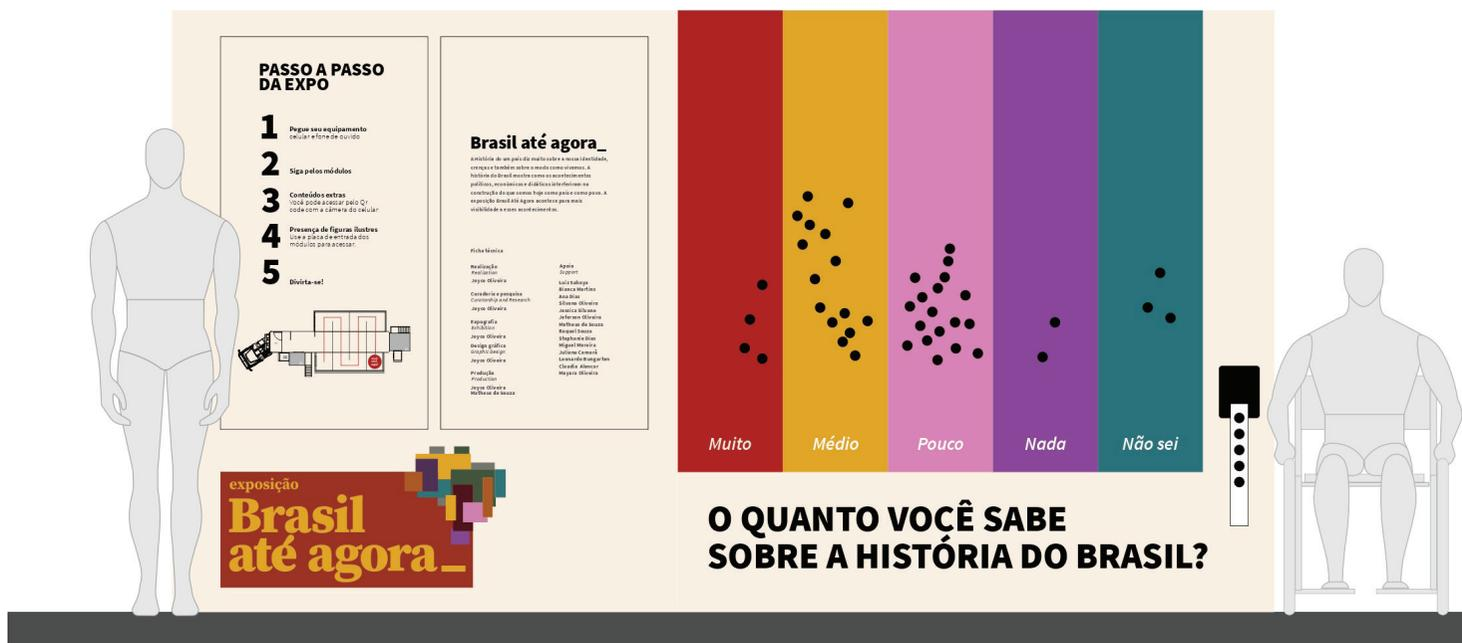
Imagem planificação da sala de introdução com modelos de figura humana usadas para verificar as alturas dos textos e posicionamento dos objetos.
