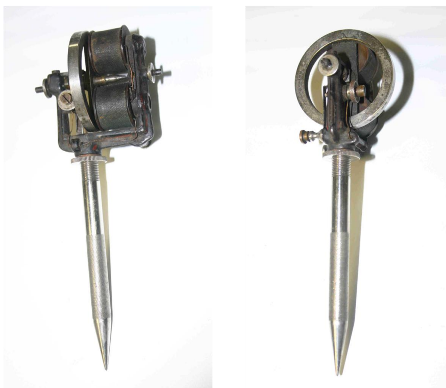
Figura 19 – caneta autographia ou impressora autográfica de Thomas Edison. Imagem retirada de “ Tattoo Machine Exhibit ”: http://www.triangletattoo.com/machines.htm
