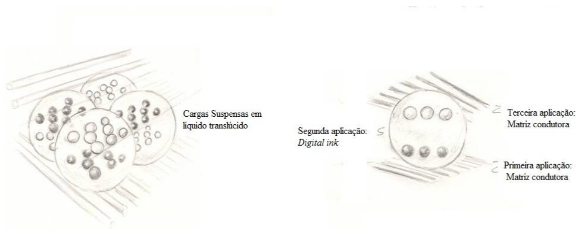
Figura 35 – Digital ink : matrizes condutoras e esferas contendo cargas suspensas. Ilustração do autor adaptado de Daigle e Campbell (2003)
