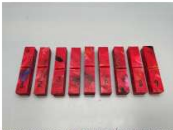
Figura 1 - Aspecto dos corpos de prova entalhados, antes do ensaio.
