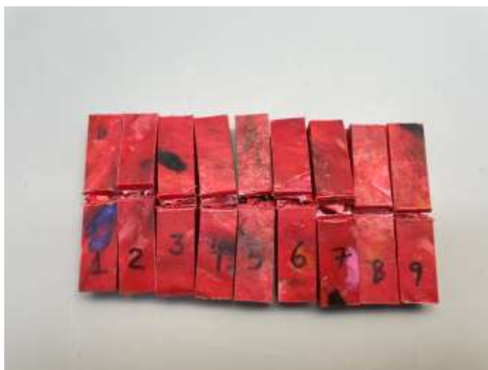
Figura 23: Aspecto dos corpos de prova após o ensaio, com as metades fraturadas postas com seus respectivos pares.
