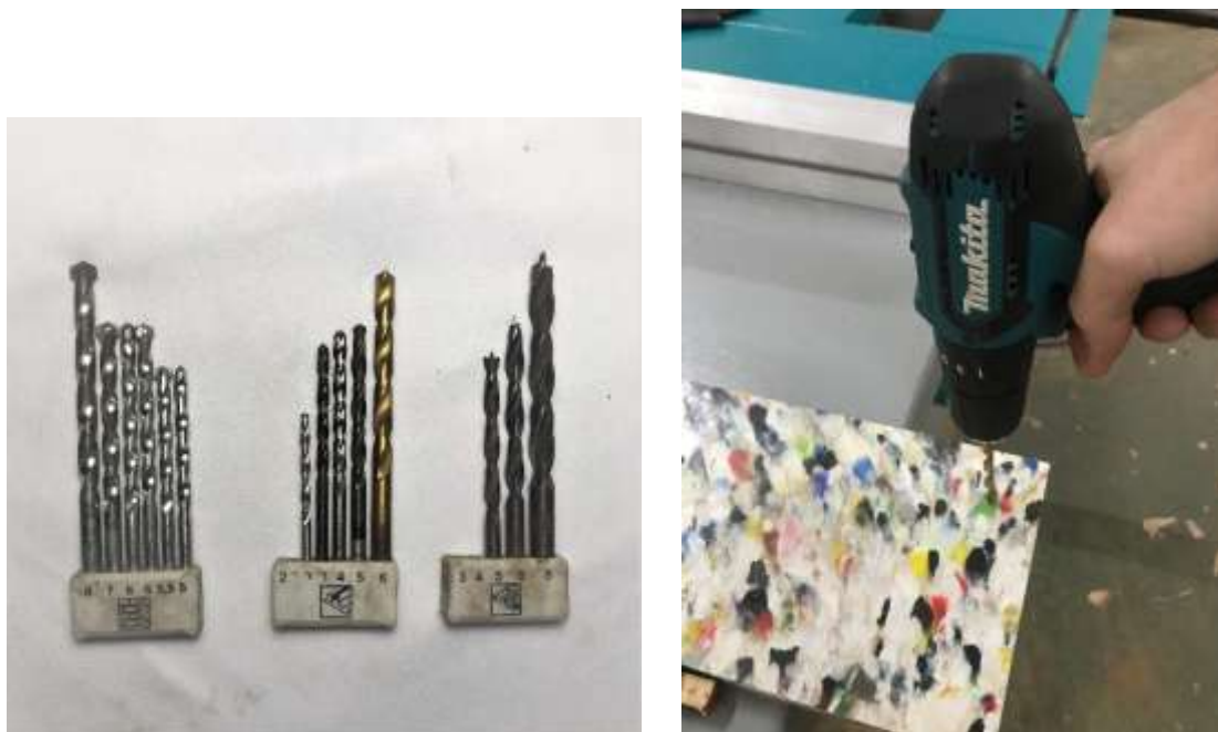
Figura 29: Teste de furação com diferentes brocas (1) Brocas (2) Procedimento.
