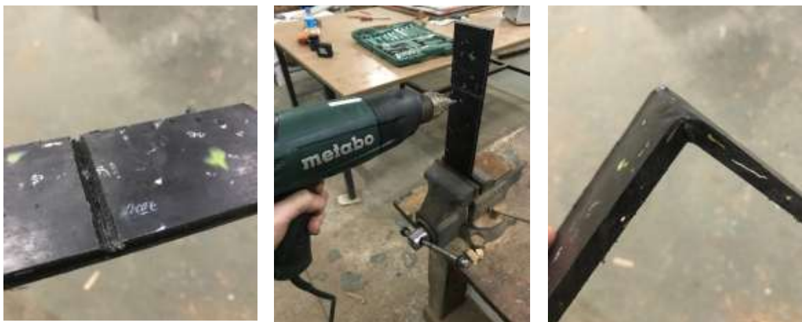
Figura 32: Etapas do procedimento de dobra. (1) Chanfro, (2) Aquecimento (3) Dobra.
