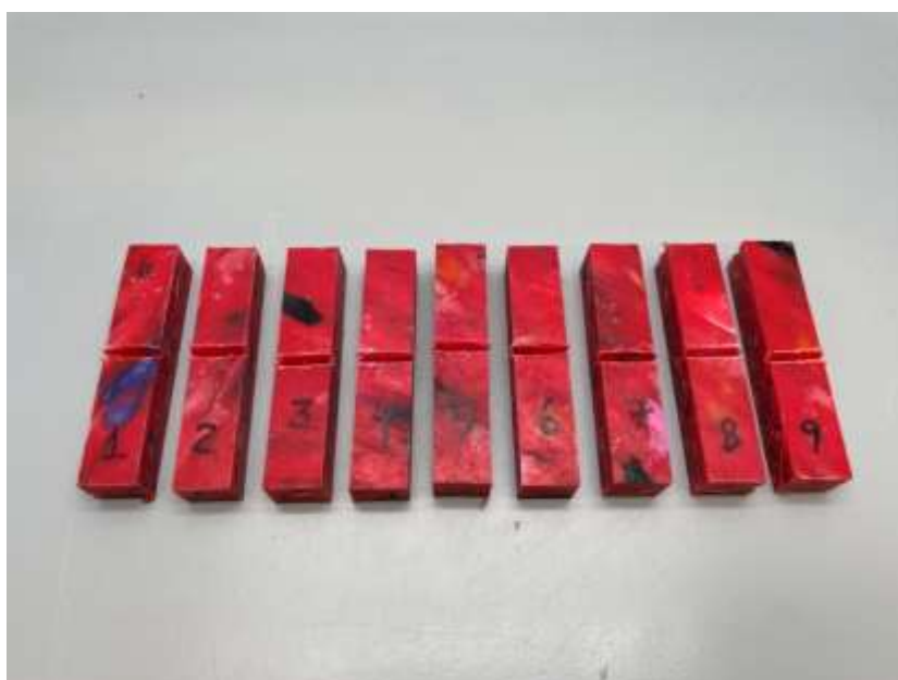
Figura 22 Aspecto dos corpos de prova entalhados, antes do ensaio.
