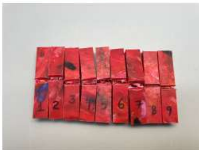
Figura 2 - Aspecto dos corpos de prova após o ensaio, com as metades fraturadas postas com seus respectivos pares.
