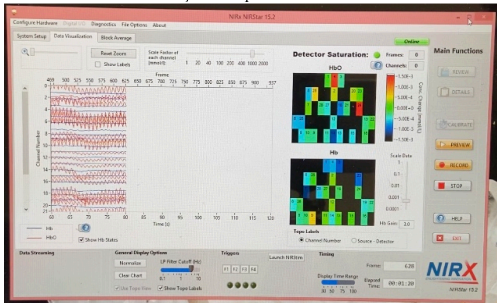
Figura 60 - Tela com a interface do software de aquisição de dados NIRStar 15.2, durante a realização do experimento.
