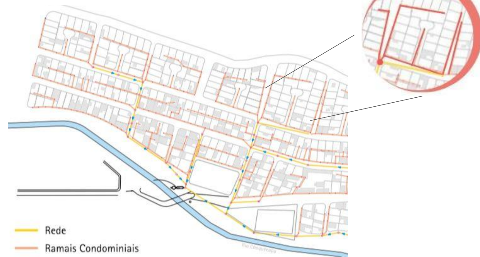
Esquema de funcionamento de uma Rede Condominial
