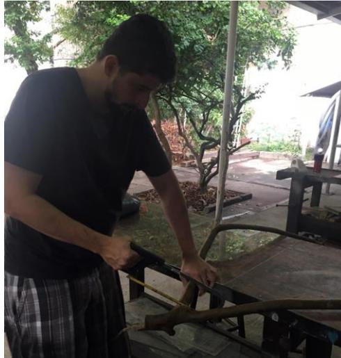
Figura 35: Poda de árvore sendo seccionada para produção de corpos de prova.
