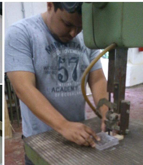
Preparação do material a ser fresado, no caso, chapas de acrílico 5mm 'sandwichadas', se preciso, até alcançarem a espessura ideal para a fresagem.
