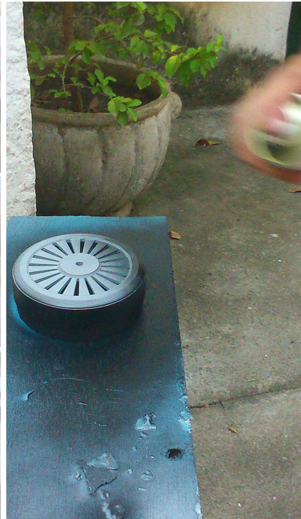
Finalizando o modelo com pintura fosca na cor preta, e detalhe em azul brilho. Foi instalado o dispositivo de curso duplo para simular o funcionamento do aparelho.
