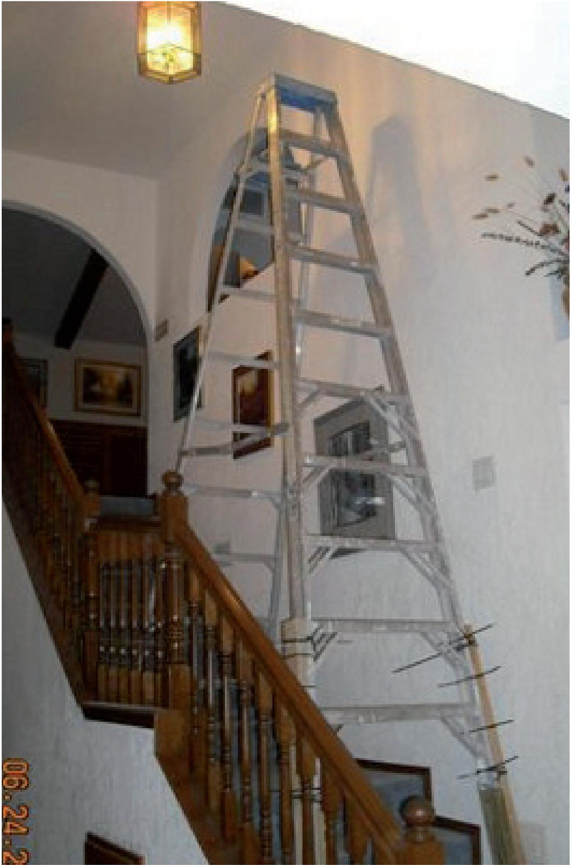
Imagem 25 - Pedacos de madeira utilizados para emendar a escadas a fim de atingir a altura necessária.
