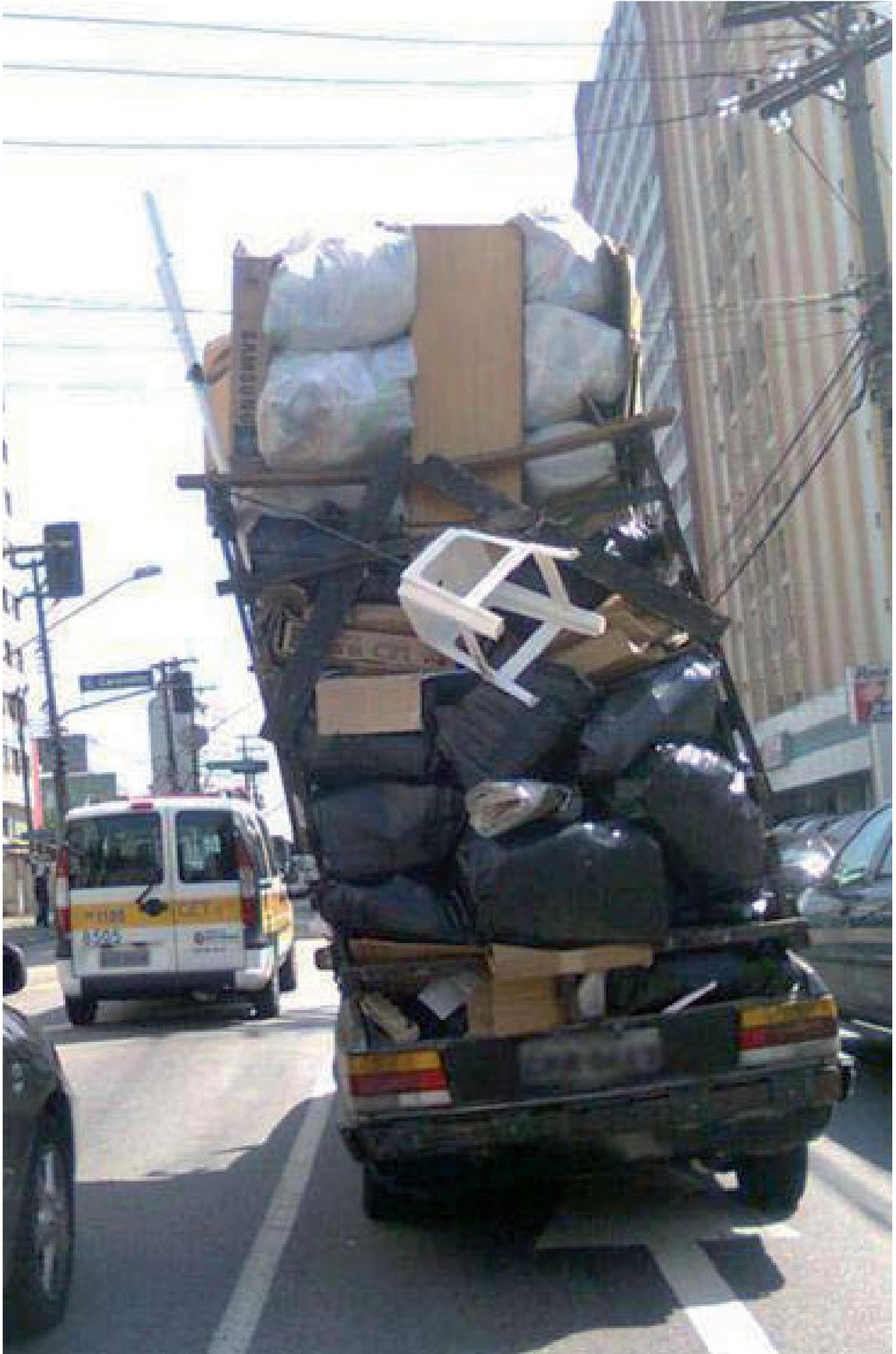
Imagem 44 - Mais um exemplo de uso além da capacidade: a carga está visivelmente inclinada, o que pode causar o tombamento do veículo e outros acidentes.
