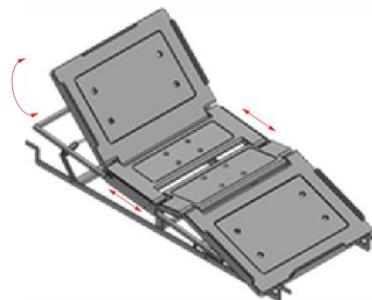
Figura 67: Região de movimentação do auto contour leito deslizante.
