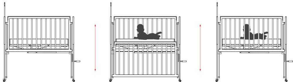
Figura 33: Acionamento do sistema de proteção lateral.
