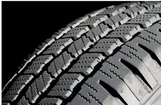
**Figura 56.** Pneu é um exemplo de produto feito de borracha vulcanizada, material de alta resistência a abrasão. (Fonte: Reso Soluções Ambientais, 2020)
