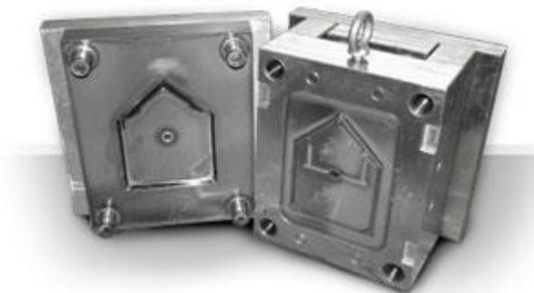
**Figura 26.** Molde para injeção. (Fonte: acervo Riplast, 2020)
