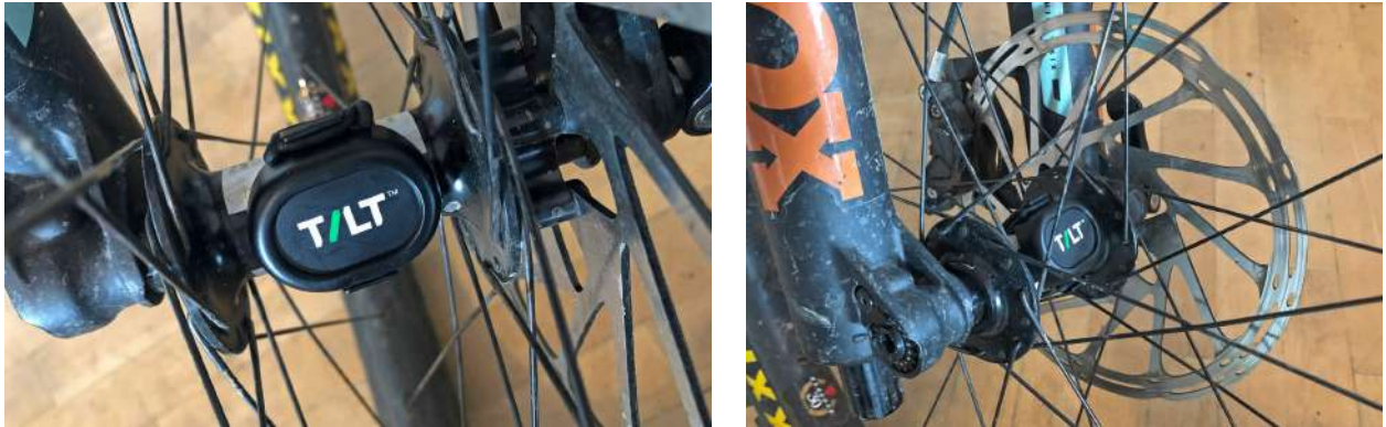
Figura 12 e 13 - Sensor TILT fixado no cubo dianteiro da bicicleta
