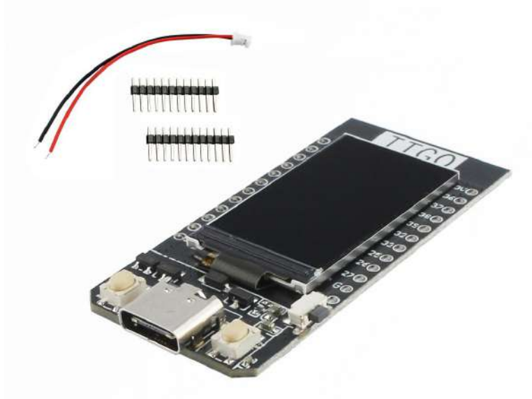
Figura 25 - Microcomputador ESP32 modelo TTGO T-Display V1.1
