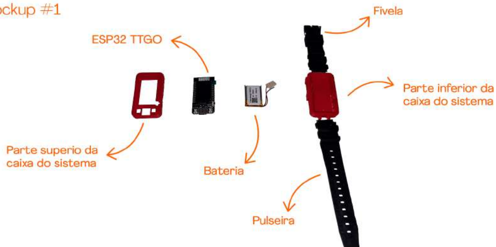
Figura 52 - Elementos do sistema no mockup
