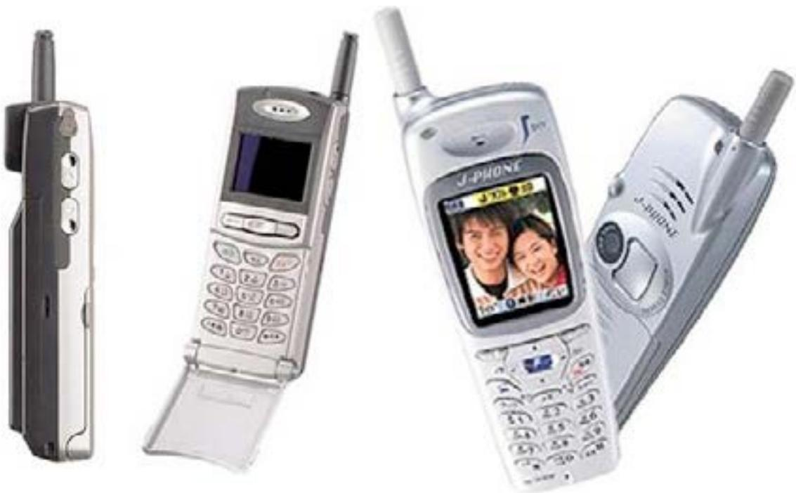
Legenda: À direita, o modelo Samsung SCH-V2000, considerado o primeiro telefone celular com câmera acoplada lançado em junho de 2000. E, à esquerda, o modelo da Sharp J-Phone, lançado em novembro de 2000 também com a câmera fotográfica. A diferença entre ambos é que modelo da Sharp, além da câmera, também tinha a capacidade de enviar as imagens eletronicamente.
