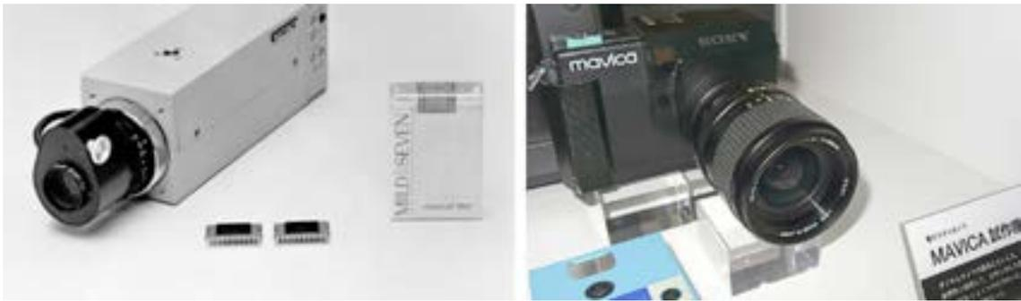
Legenda: À esquerda, o modelo XC-1, a primeira câmera com CCD colorido. À direita, um dos protótipos da câmera Mavica.
