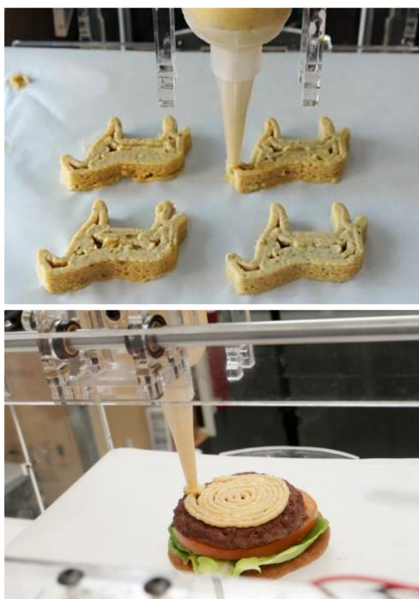
Figura 20. Alimentos sendo impressos pela Foodini
